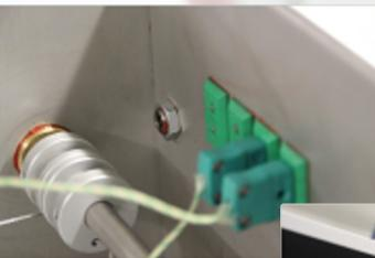
добавлен воздушный клапан, обеспечивающий более легкое открывание крышки рабочей камеры после отработки цикла пайки
